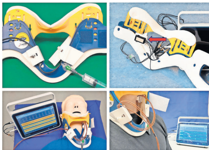
Abb. Links oben: Ansicht von außen. Rechts oben: Ansicht von innen, roter Pfeil zeigt auf den Sensor. Links unten: System am Phantom mit Steuerungseinheit. Rechts unten: System an Mitarbeiter. Foto: ICCAS; Stefan Straube (Abb. rechts oben)
